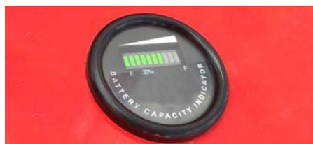
Groupe de batteries de 24V, ayant une durée de vie de 1 100 cycles de charge et avec un afficheur externe indiquant l'autonomie. Chargeur de batteries dernière génération permettant une charge rapide. Cet équipement permet de faire 30 lavages au défilé.
