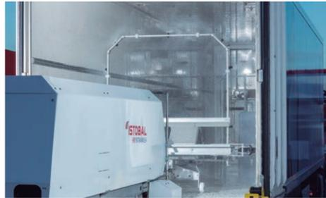
Système de dosage parfaitement contrôlé pour une désinfection appropriée de l'intérieur du véhicule. L'équipement peut fonctionner avec deux produits chimiques différents, à choisir selon le type de charge à laver et/ou à désinfecter.
