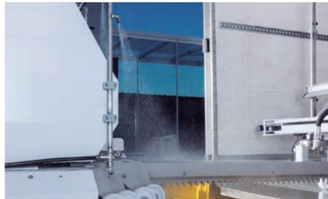
Pour maintenir l'équipement toujours propre, ISTOBAL HW'INTRAWASH comprend un système auto-nettoyant qui évite l'entrée de saleté dans le module de guides et dans les chaînes porte-câbles.
