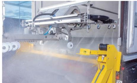
Bras mobile à haute pression 70 bar, avec des buses rotatives et un système mobile qui produit un effet de balayage permettant d'atteindre tous les recoins de l'intérieur du véhicule.
