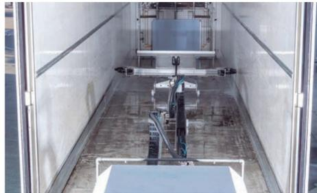
Bras en acier inoxydable entraînés par un convertisseur de fréquence permettant d'ajuster les vitesses de chaque passage du programme.
