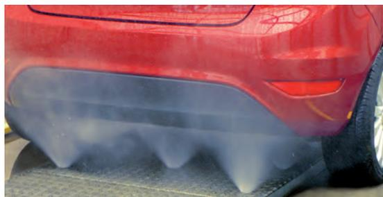
L'option idéale pour un lavage intégral pour vos clients les plus exigeants. Lavage châssis fixe 10 bar, 90 L/min, ou oscillant 15 bar, 120 L/min.
