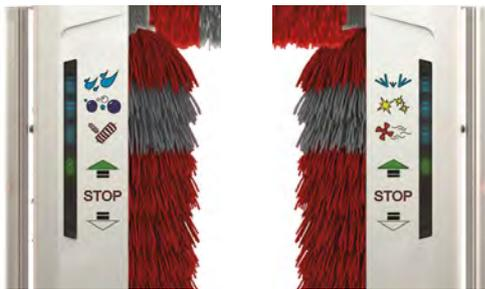
Feux lumineux avec indication des phases de lavage, feux de position et positionneur. Disponible sur le carénage ZENIT.
