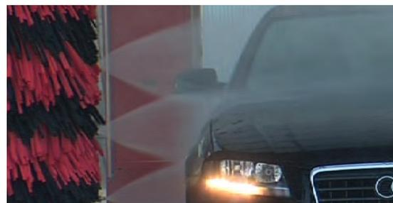
Une large gamme de prélavages haute pression pour préparer le véhicule pour un nettoyage parfait. Disponibles en: 15 bar et 120 l/min., 80 bar et 42 l/min. ou 80 bar et 84 l/min.
