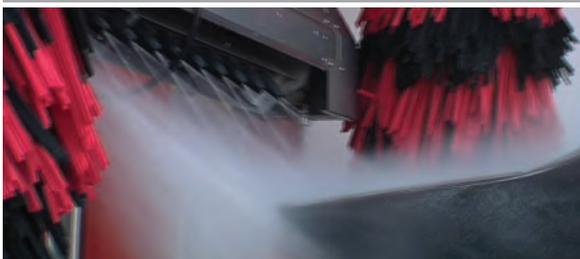
Montée sur le module de lavage, la haute pression supérieure oscillante, équipée de 14 buses rotatives, permet de laver efficacement tous les derniers recoins du véhicule.
