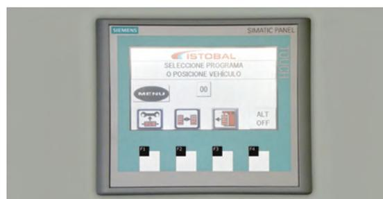
Écran tactile couleur de dernière génération intégré dans un poste de commande fonctionnel facilitant la connexion et le contrôle de toutes les options de votre portique de lavage.
