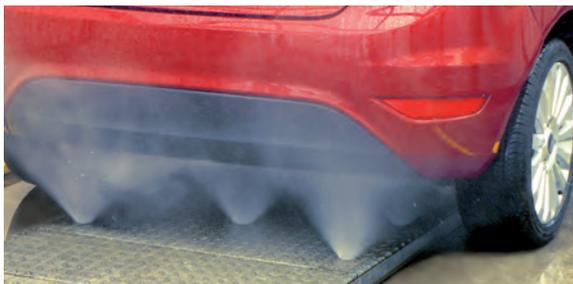
Lavage châssis fixe 10 bar, 90 L/min, ou oscillant 15 bar, 120 L/min.
